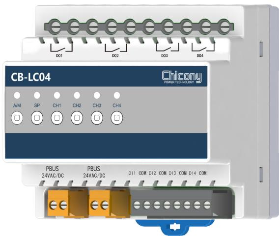
CB-LC04是CB系列繼電器控制模組產品之一，廣泛應用於智能照明、安防報警等機電設備控制領域，具有4路數位輸入、4路繼電器輸出功能；數位輸入可接入開關、報警、紅外人體感測器等訊號，繼電器輸出可控制照明、電機等開關迴路。
