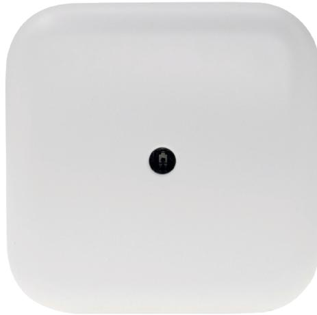
SN1220屬於iSens系列產品，垂直點光源的收光方式，透過4mA ~ 18mA 類比輸出連接AI控制器，收集環境照度資訊，讓智慧照明系統平台得以決策合宜的照明程度並達到節能的效果，適用於翻新建物和新建大樓。
